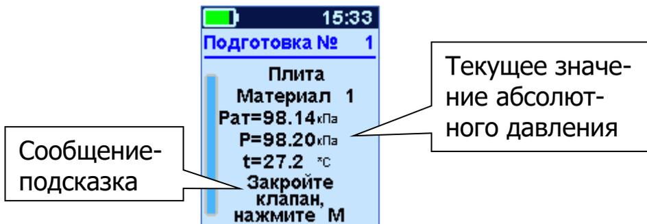
6.4.9 После создания в камере предварительного вакуумирования разряжения воздуха требуемой величины  $P_{абс} \leq 35$  кПа ( $P_{вак} \geq 65$  кПа) на индикаторе появится надпись с предложением начать регистрацию, нажав кнопку **М**.
