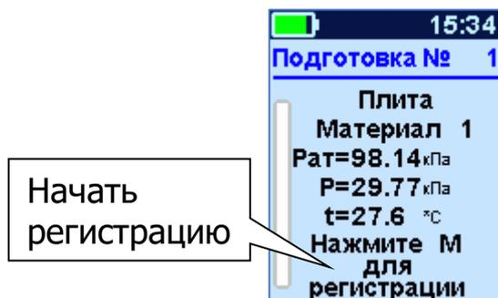
6.4.10 Начать измерение, нажав кнопку **М**, и в течение 1 минуты открыть главный клапан, повернув переключатель 6 с маркировкой «**Главный клапан**» в положение «**ОТКРЫТ**» (Рисунок 1).
